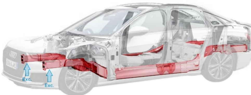
1. ábra A személyautó karosszéria két fő hossztartója, amin a mérési pontok elhelyezkednek, valamint a gerjesztések helye nyilakkal jelölve [3,4]
