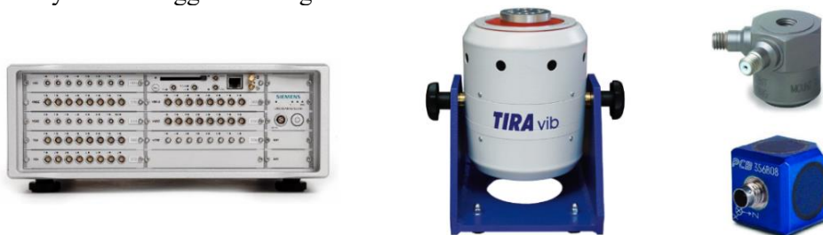
4. ábra A méréshez használt eszközök: Siemens LMS Scadas Mobile frontend, Tira 51110 shaker, PCB 288D01 impedancia szenzor és PCB 356B08 triaxiális gyorsulásmérő
