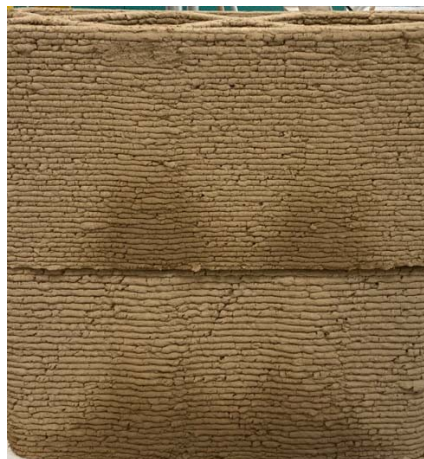
33. ábra - Alul 20 mm, felül 16 mm átmérőjű extruderfejjel nyomtatott rétegek
