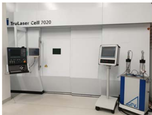
2. ábra. Trumpf Trulaser Cell 7020 típusú berendezés a poradagoló egységgel és az LMD fej
