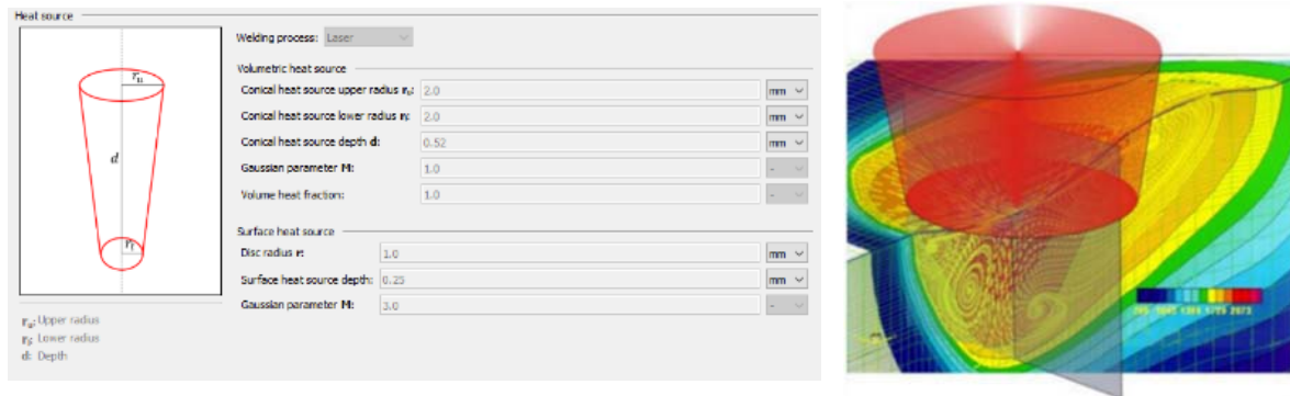
5. ábra. A lézer hőforrás modellezése csonka kúppal [6]
