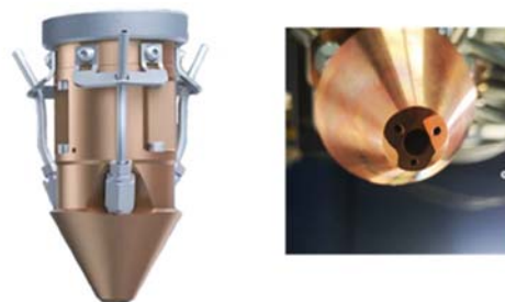
2. ábra. Trumpf Trulaser Cell 7020 típusú berendezés a poradagoló egységgel és az LMD fej
