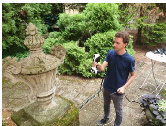
3. ábra. Sérült homlokzati elem szkennelése SCANTECH iReal 2E Color kézi 3D szkennelssel
