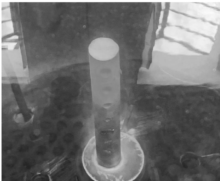
3. ábra: Az üregkátód hatás aktív zajlása okán túlhevült darab
