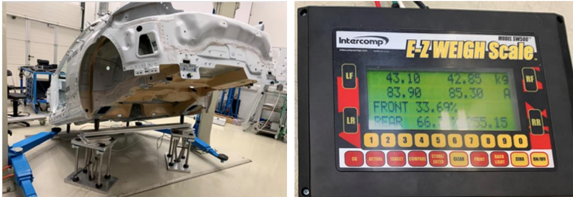
3. ábra Mérleges mérési módszer a karosszéria megdöntésével
