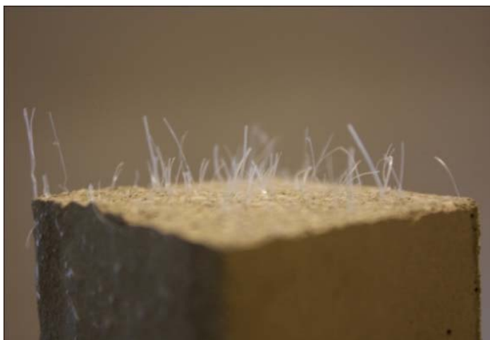
12. kép Szálerősített beton törésképe
