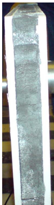
2. kép A dermesztett teherhordó homokbeton héjszerkezet
