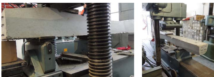
2.11. ábra. A vasúti betonlajak laboratóriumi vizsgálata [8]
