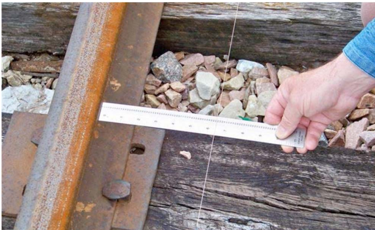
2. ábra. A húrmérés folyamatának lépései és felhasznált eszközei
