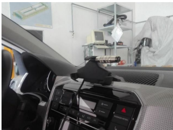
8. ábra Ipari mikrofon elhelyezése az utastérben
