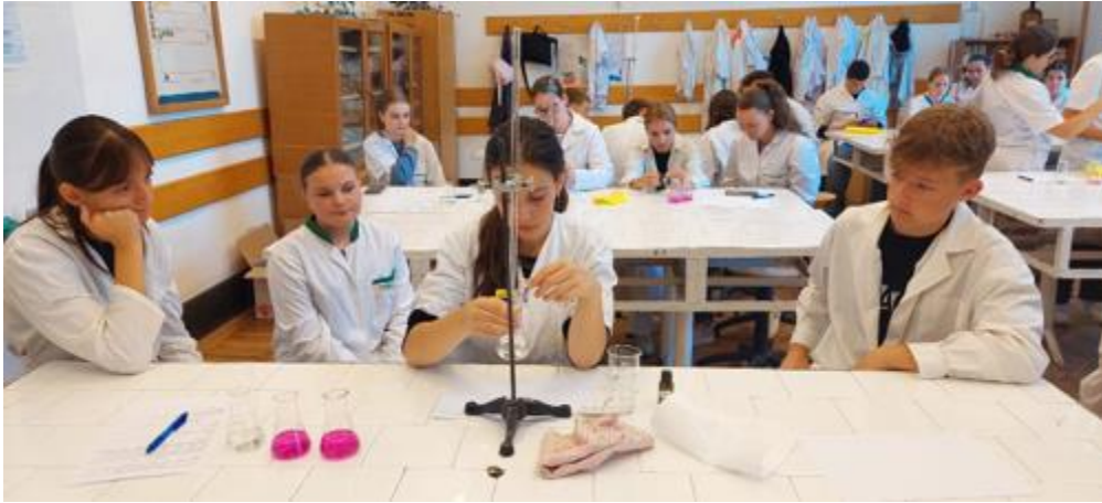
9. ábra Az étacet titrálása nátrium-hidroxiddal
