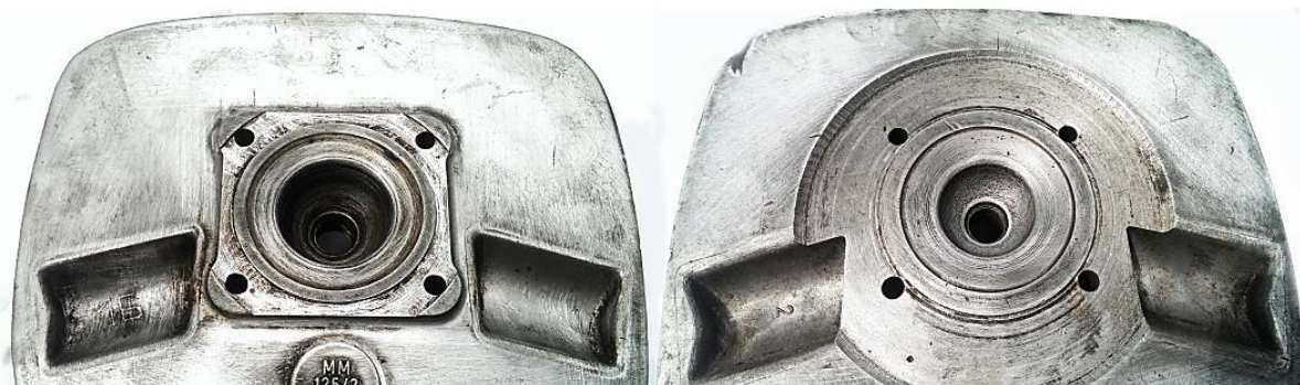
8. ábra A gyári (bal), és a módosított (jobb) hengerfej [saját felvétel]
