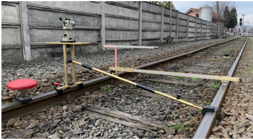
6. ábra. Optikai hűrmérés módszere
