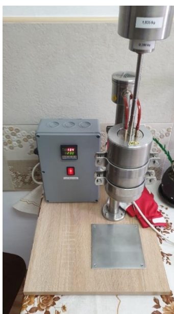
3. ábra. A megvalósított kapilláris plasztométer
