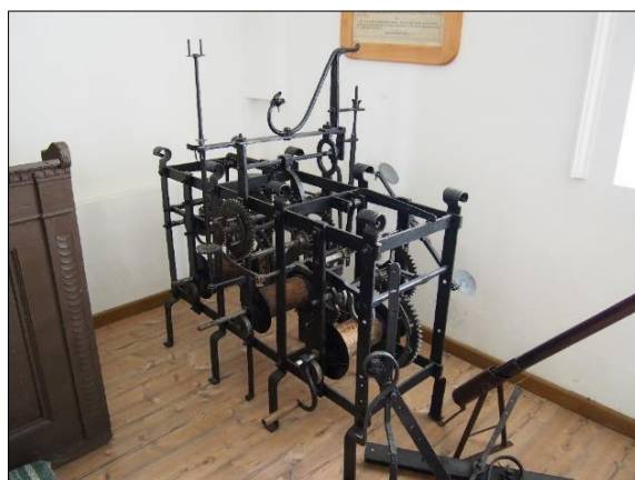
14. kép A németi torony óraszerkezete
