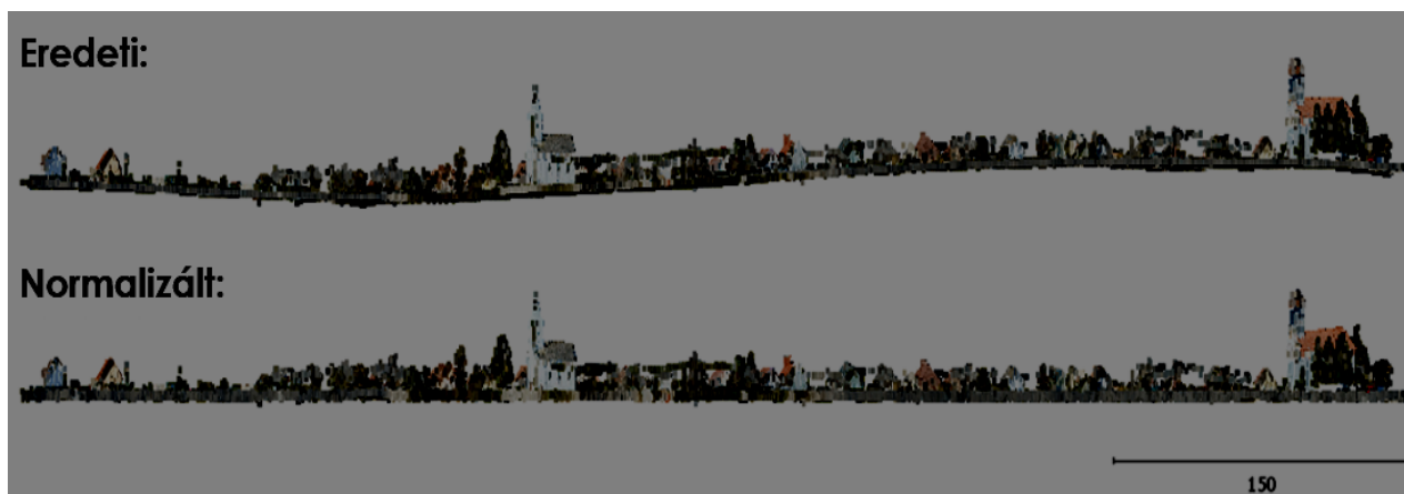
2. ábra Felül: eredeti pontfelhő oldalnézetben, alul normalizálás után
