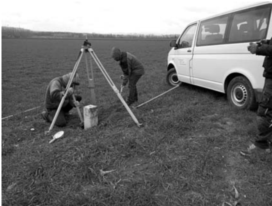
Vegyes szakértői csoport kidőlt határjelet megfelelő helyére tesz a B IV alszakaszon
