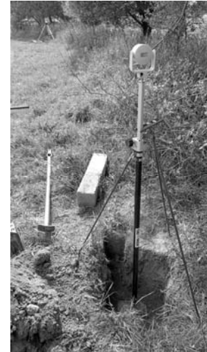
Van ahol csak hagyományos módszerrel lehet mérni. Mérőállomással tudunk sztereografikus rendszerben is mérni, GNSS technológiával csak helyi transzformációval lehetne megoldani.
