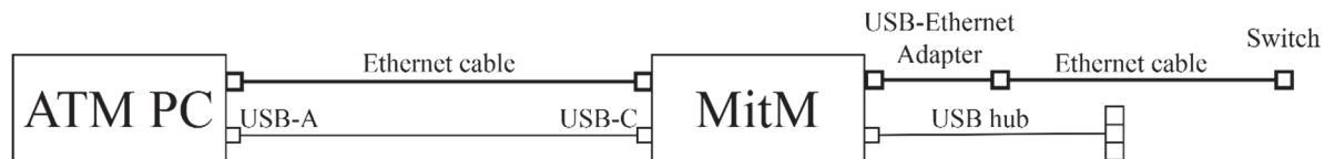
2. ábra. Közbeékelés USB és Ethernet kábelre
