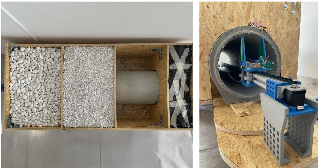
4. ábra. Csatorna teszt elrendezése és GPR szenzor tesztelése.
