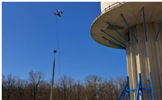
7. ábra: Közeltéri drón-platform alapú spektrum mérés a Püspökladányi Radarállomáson (bal); a drón platform az „S” sávú microstrip antennával felszerelve [szerzők saját képe]
