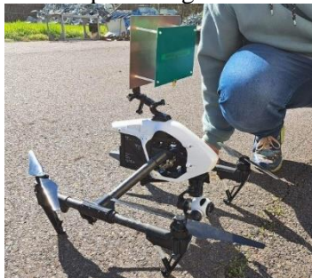
1. ábra: DJI Inspire 1 drón az egyetemen fejlesztett „L” sávú antennával [szerzők saját képe]
