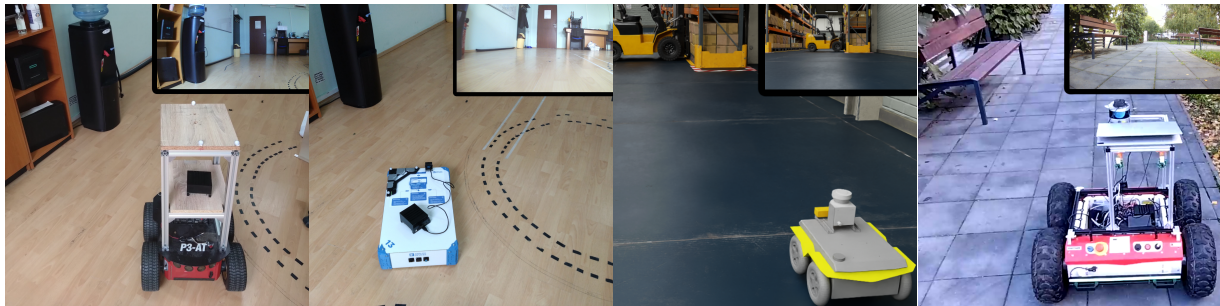
1. ábra. A felhasznált robotplatformok: Pioneer 3-AT, AD-R1M, Clearpath Jackal, Husarion Panther
