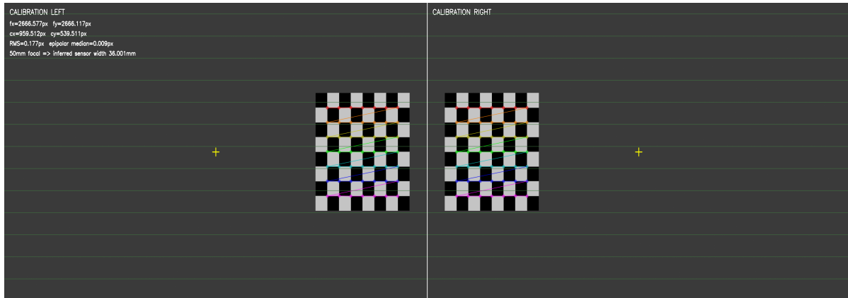
1. ábra. A sakktáblás kalibráció két nézete, az azonosított belső sarokpontokkal
