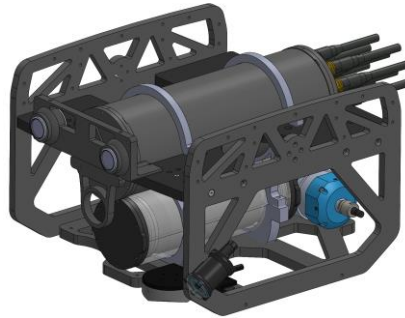
1. ábra: UG-1 egyedi fejlesztésű vízalatti kutatórobot 3D modellje
