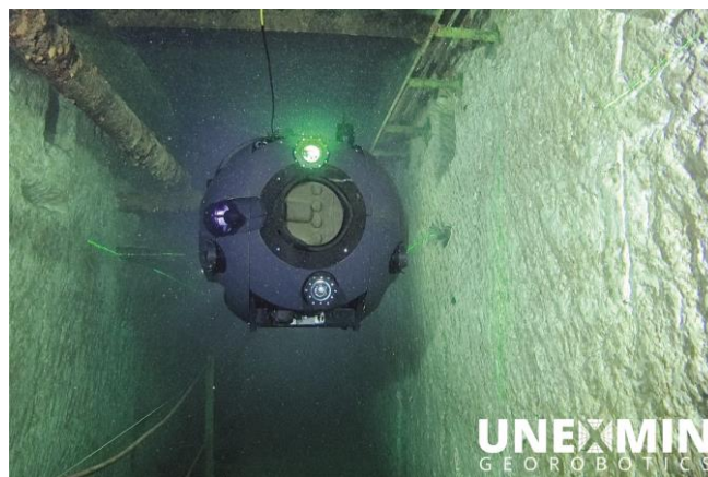
2. ábra UX1-Neo egyedi fejlesztésű vízalatti kutatórobot bevetés közben
