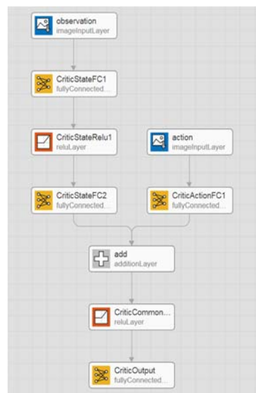
11. ábra. A kritikus háló architektúrája
