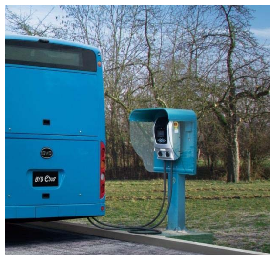
11. kép Utcai töltőállomás Shenzenben (BYD)
