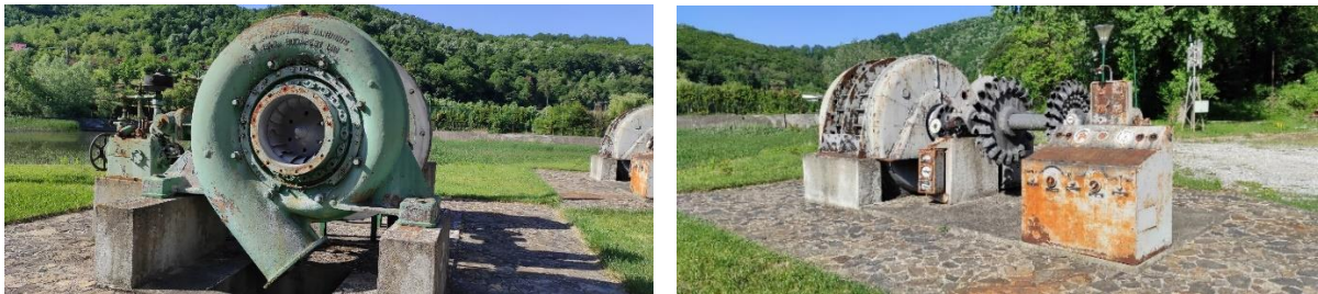
7. ábra: A régi brázovai Francis- és greblai Pelton gépcsoport
