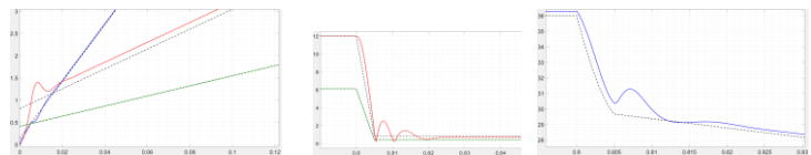
10. ábra. A VCI-SiS-vel szimulált görbék kinagyított részletei: indítás (bal oldalt), illetve 0.8 s után az áram (középen), és a feszültség (jobb oldalt) fékezéskor.
