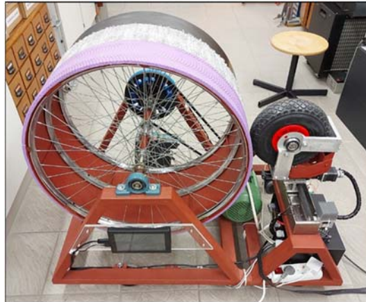
2. ábra. Az elkészített mérőberendezés a három különböző felületi paraméterekkel rendelkező bevonattal.
