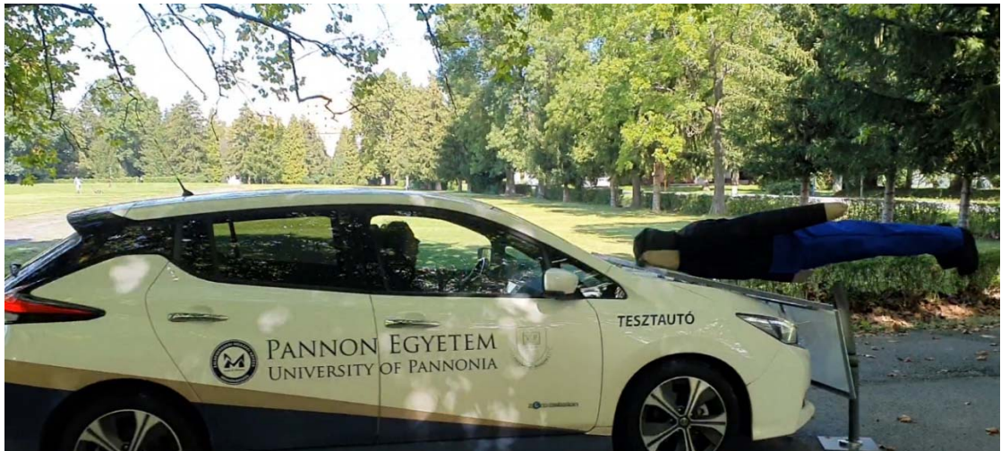
4. ábra. A bábu elütése 20 km/h sebességgel
