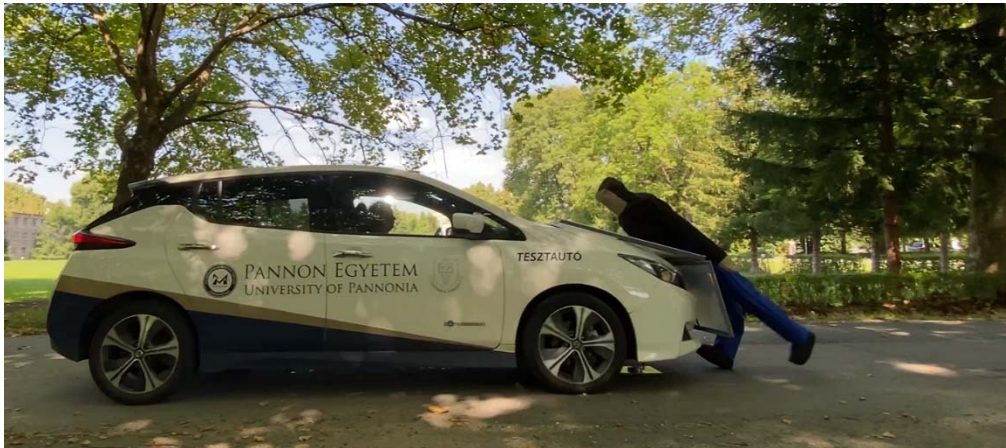
2. ábra. A bábu elütése 10 km/h sebességgel.
