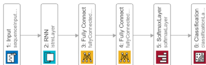
9. ábra. Az LSTM RNN felépítése
