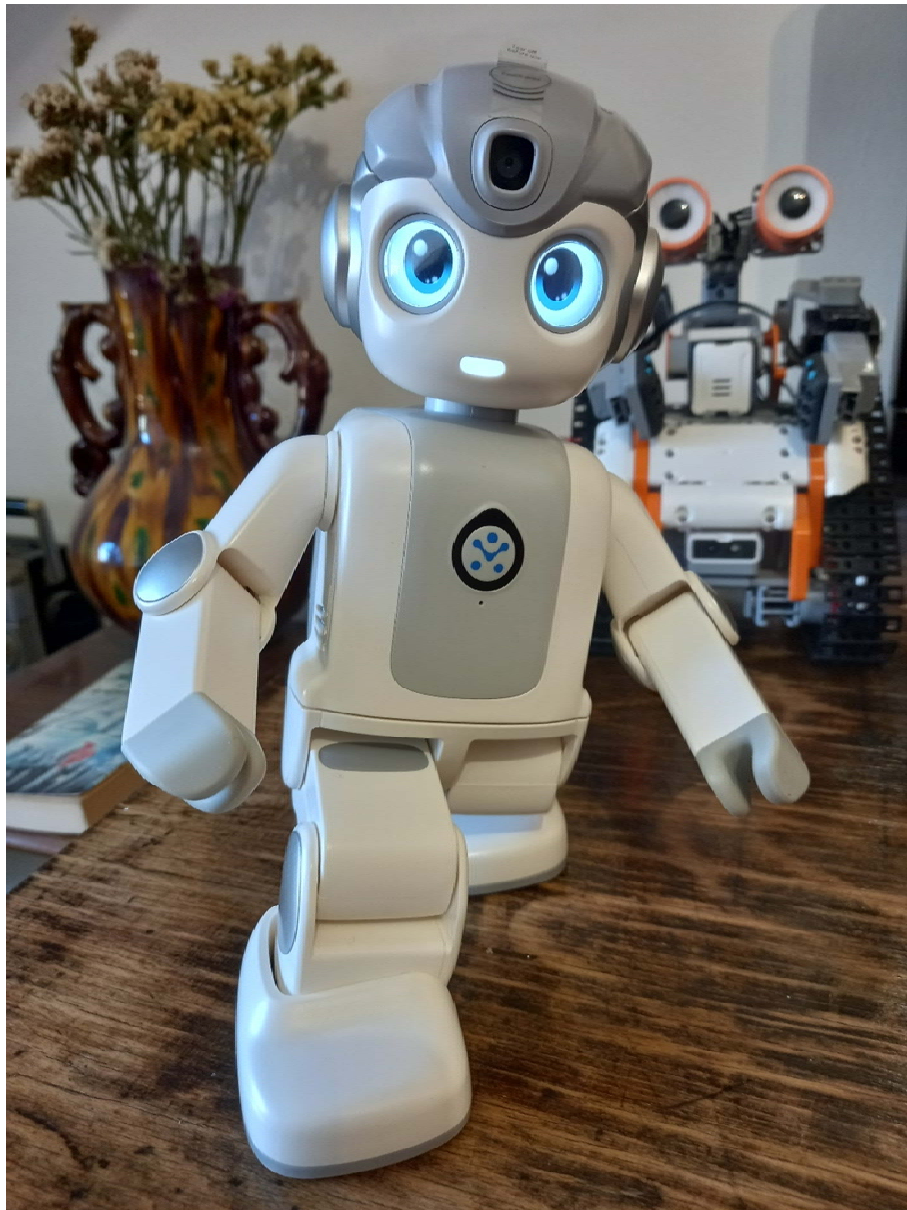
3. ábra UBTECH AlphaMini Edukációs célú, szabadon programozható, hangvezérelhető humanoid robot
