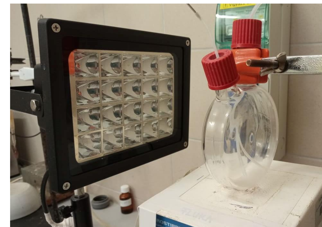
UV LED: λ max = 395 nm, 60 W fény intenzitás = 7,6 mW cm -2
