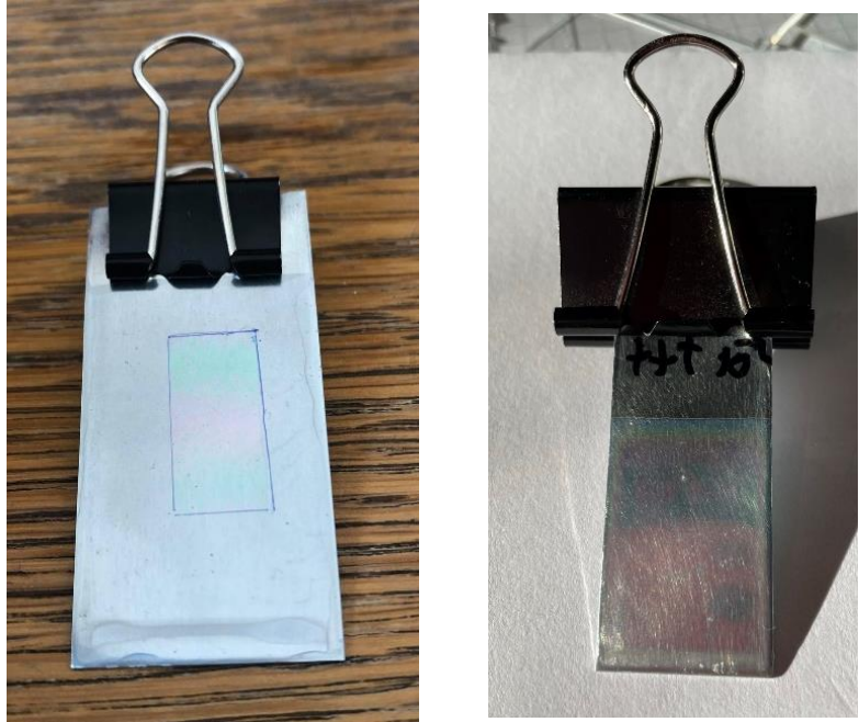
Kitozán (bal) valamint fenolftaleinnel impregnált kitozán (jobb) réteg cink hordozón
