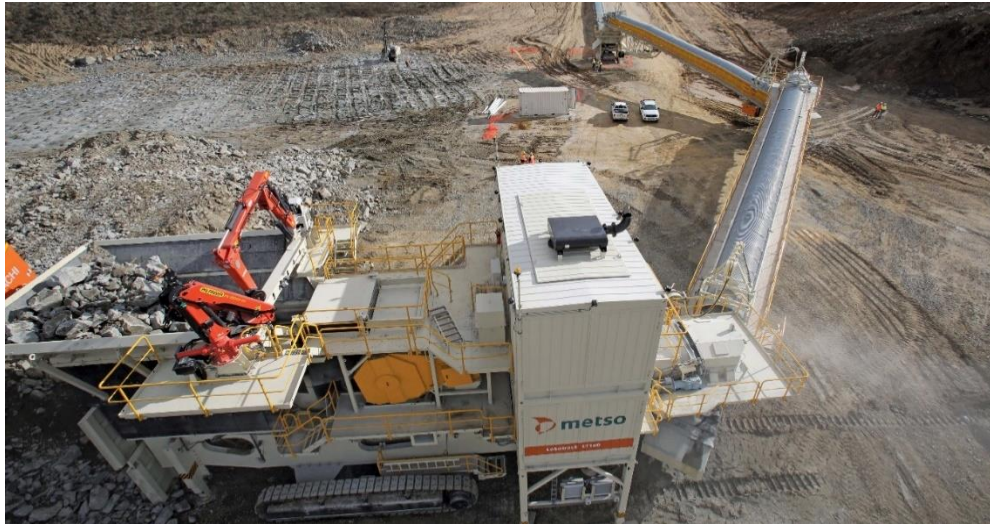
2. ábra: Az ausztrál Boral Peppertree bánya Metso gyártmányú FMIPCC előtörése. [7]
