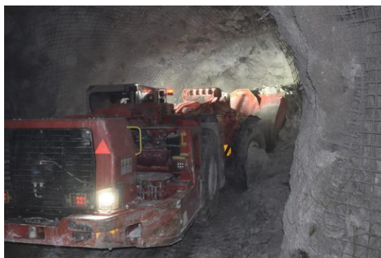
2. ábra LHD gép az egyik kamrafejtésben. A felvételen jobbra látható a löttbetonba ágyazott háló [1]
