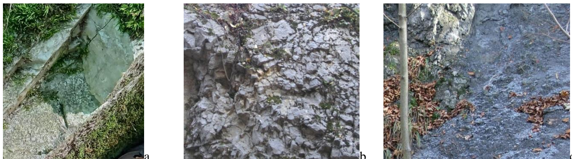
2. ábra. Kevésbé tagolt, jó megtartású (a), illetve erősen tagolt, törésekkel sűrűn átjárt (b), valamint teljesen felmorzsolott (c) mészkőtestek a Bükk hegységben
