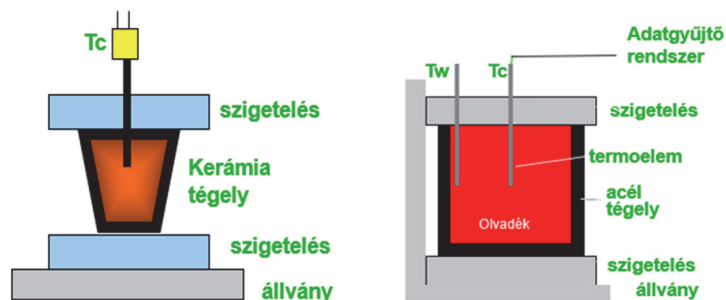
1. ábra Az 1-termoelemes módszer (bal) és a 2-termoelemes módszer elvi elrendezése (jobb)
