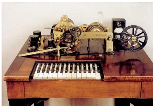
2. ábra. Hughes-féle betűíró távirógép [2]
