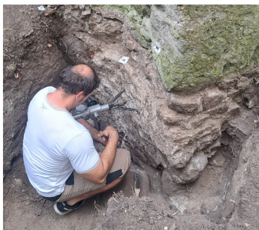
8. ábra: Habarcsvizsgálat próbafúrással vizsgálati helyszínen és laboratóriumban
