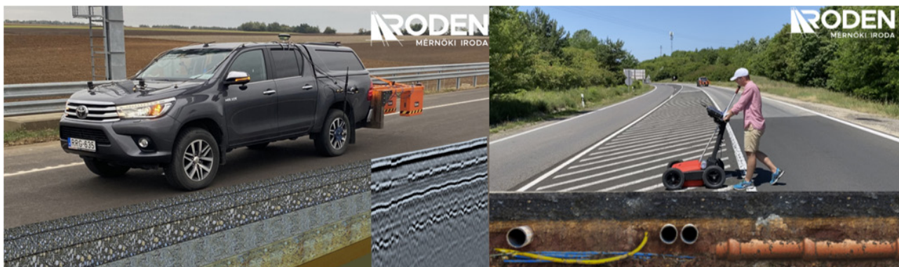
2. ábra. A RODEN Mérnöki Iroda útpályadiagnosztikai mérőrendszere (bal); kézi földkapcsolt georadar antenna (jobb)
