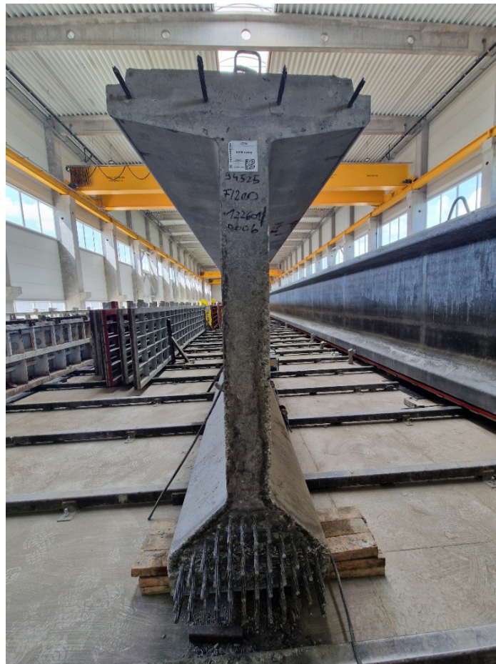
12. ábra. GINOP_PLUSZ-2.1.1-21-2022-00095 kutatásban kifejlesztett 2 m magasságú, max. 800 kN önsúlyú előrefeszített hídgerenda
