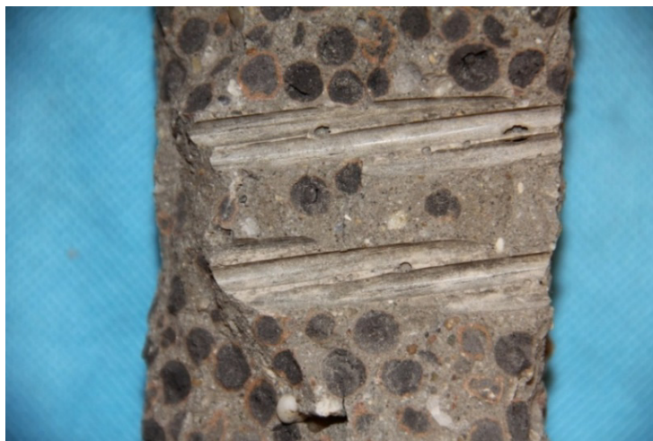
6. ábra. Kísérleti könnyűbeton gerendában a feszítőbetét tapadása
