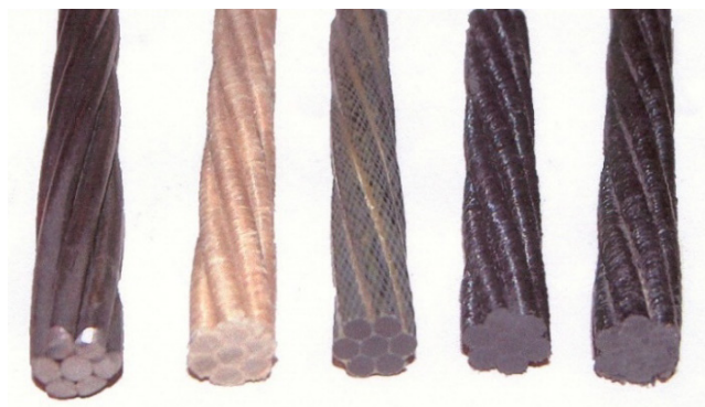
7. ábra. Különböző anyagú 7-eres feszítő pázmák, balról jobbra: acél feszítőpászma, aramid szálas feszítőpászma és szén szálas feszítőpászma
