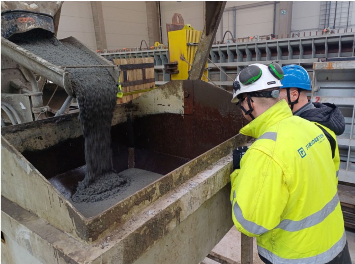
3. ábra. A hídgerendák öntéséhez használt certydes beton vizsgálata
