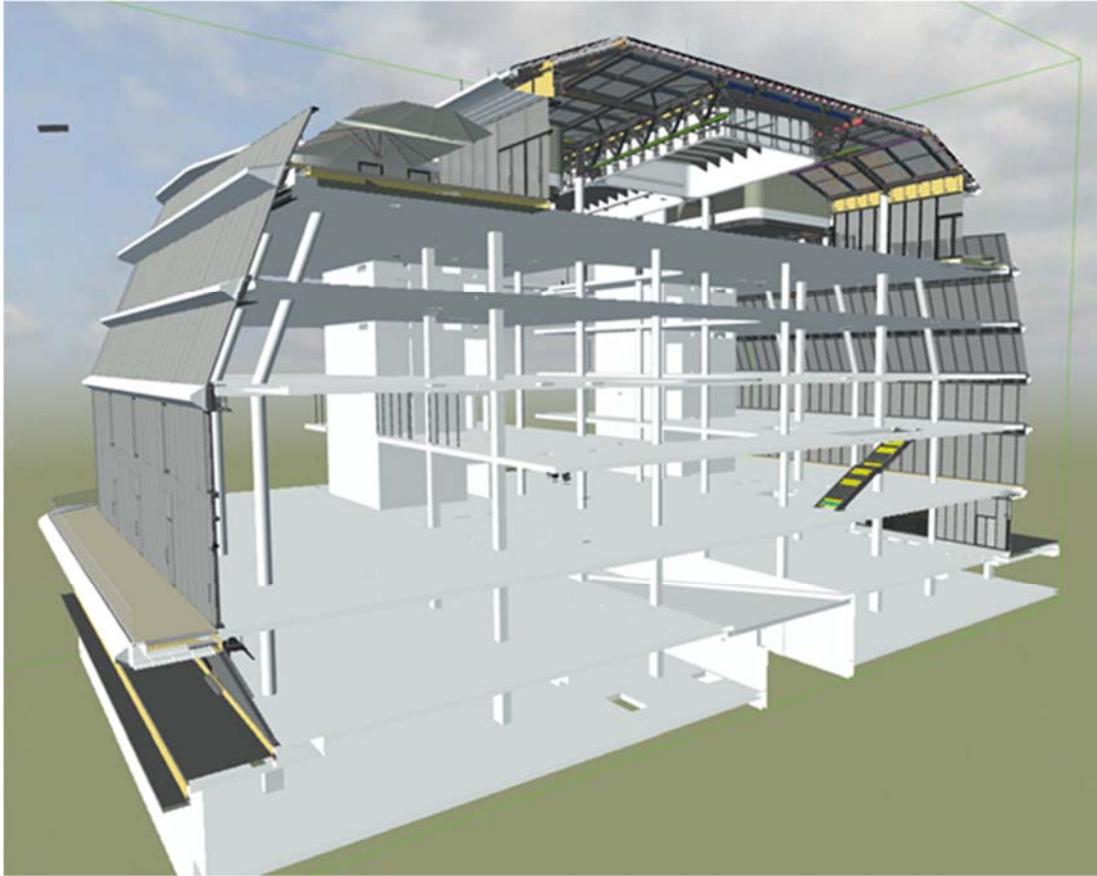
8. ábra. Pódium épület térbeli keresztmetszete
