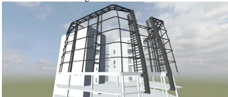
1. ábra. Korona acélszerkezete
