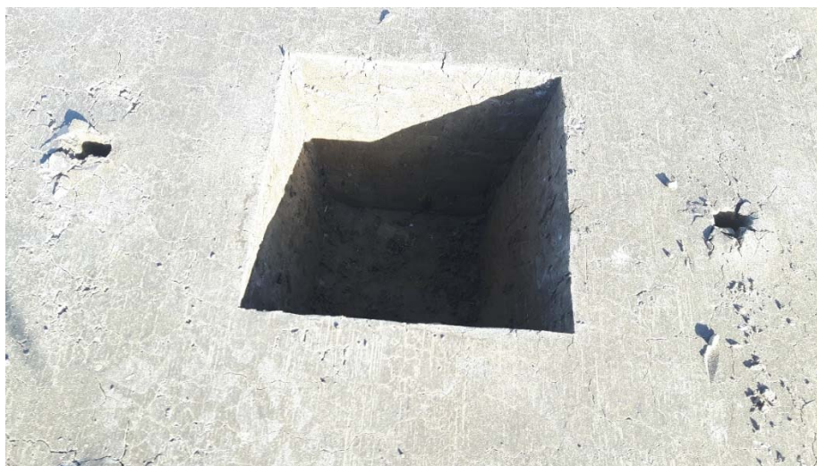
2. ábra Tömörség mérés talaj javítás után: Hala NTN Sibiu
