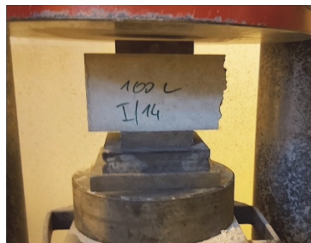
2. ábra: Nyomószilárdság meghatározása félhasábon
