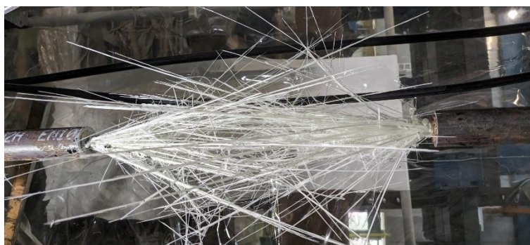
3. ábra. GFRP betét szakadása
