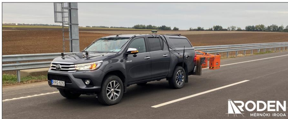
1. ábra. A RODEN Mérnöki Iroda útpályadiagnosztikai mérőrendszere
