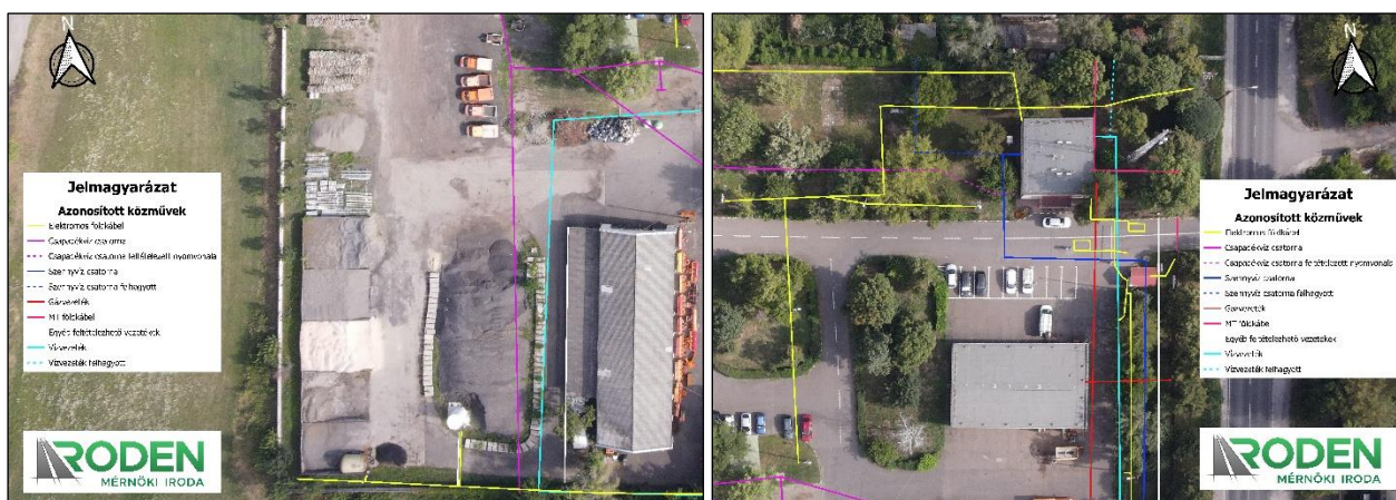
9. ábra. Közművezetékek radarmérés alapján feltárt nyomvonalai
