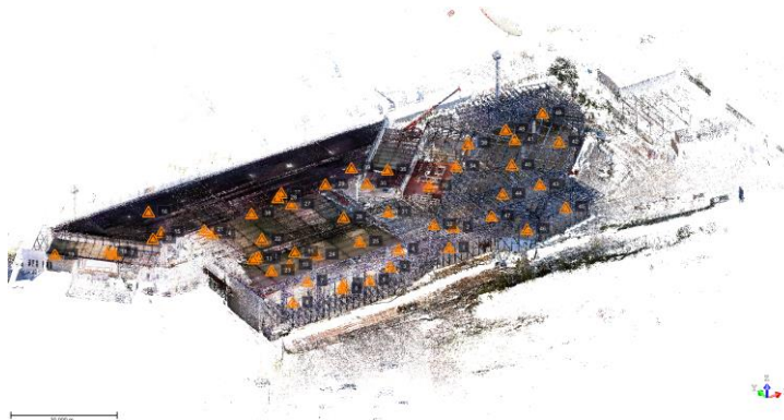
8. ábra. A 3D szkennelésből származó pontfelhő
