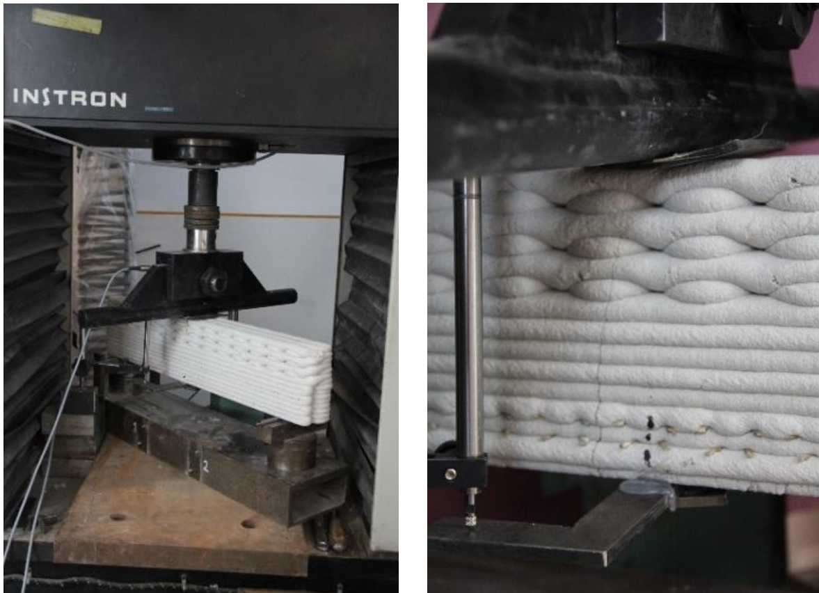
5. ábra 3D nyomtatott betongerenda hajlítási vizsgálata betétek nélkül
