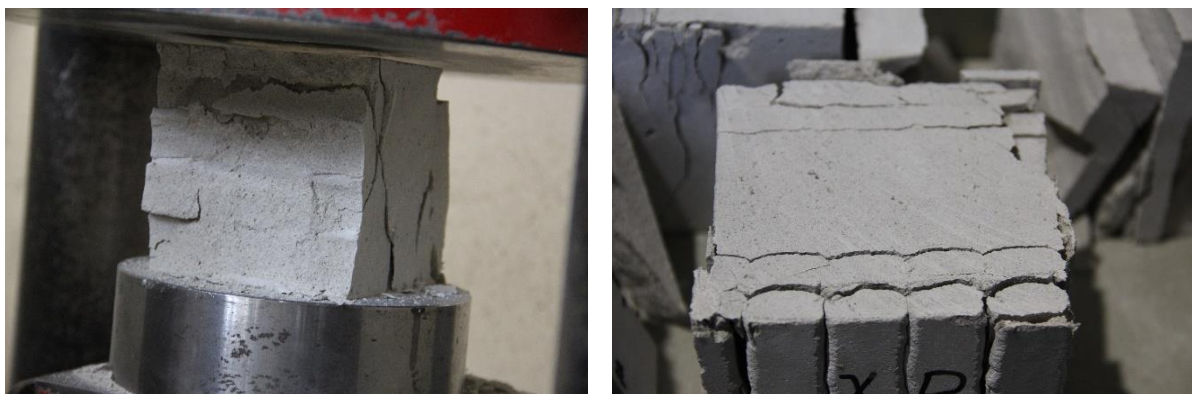
3. ábra Nyomatott beton nyomóvizsgálatai eltérő irányokban (a nyomtatási irányhoz képest)
